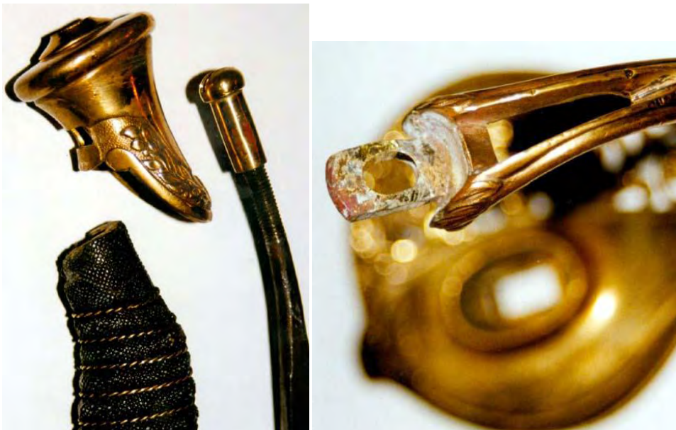
Angel mit Angelmutter, Griffkappe und Griffstück. Die Führung für die neue Angelmutter am Bügel.
